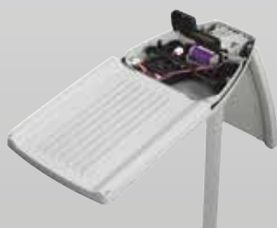
Communication bi-directionnelle par courant porteur (CPL) via le protocole LONWorks
